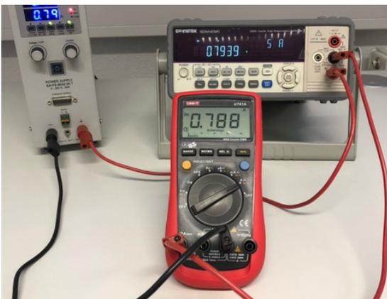
Gemäß DIN EN ISO 9001 müssen Errichterbetriebe für qualitätsrelevante Aufgaben, z.B. Wartung und Instandhaltung von Netzgeräten, kalibrierte Messgeräte einsetzen. Da die regelmäßige Kalibrierung von digitalen Multimetern für Errichter mit einem hohem Auf-
