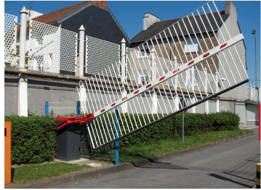
Die Schließgeschwindigkeit ist ggf. gegenüber der Öffnungsgeschwindigkeit zu reduzieren, um die maximalen Schließkräfte der nachfolgend ausgeführten Normen einzuhalten.
