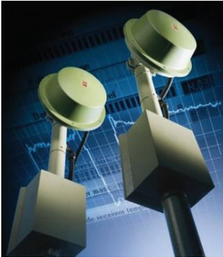
Zwischen einem Sender und einem Empfänger, die sich in einem bestimmten Abstand gegenüber stehen, wird ein unsichtbares, elektromagnetisches Feld erzeugt. Dieses Feld ist ellipsenförmig mit einem maximalen Durchmesser von etwa drei bis fünf Metern. Ein Mensch oder Objekt, der bzw. das sich zwischen Sender und Empfänger bewegt, verändert das elektromagnetische Feld und wird als potenzielles Alarmereignis registriert.
