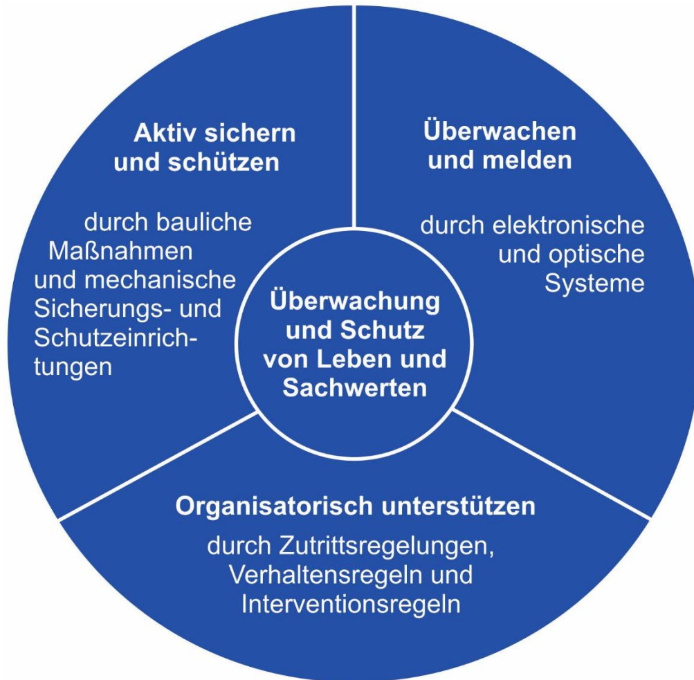
Bild 5-1 Gesamtkonzept von Sicherungs- und Verifikationsmaßnahmen
