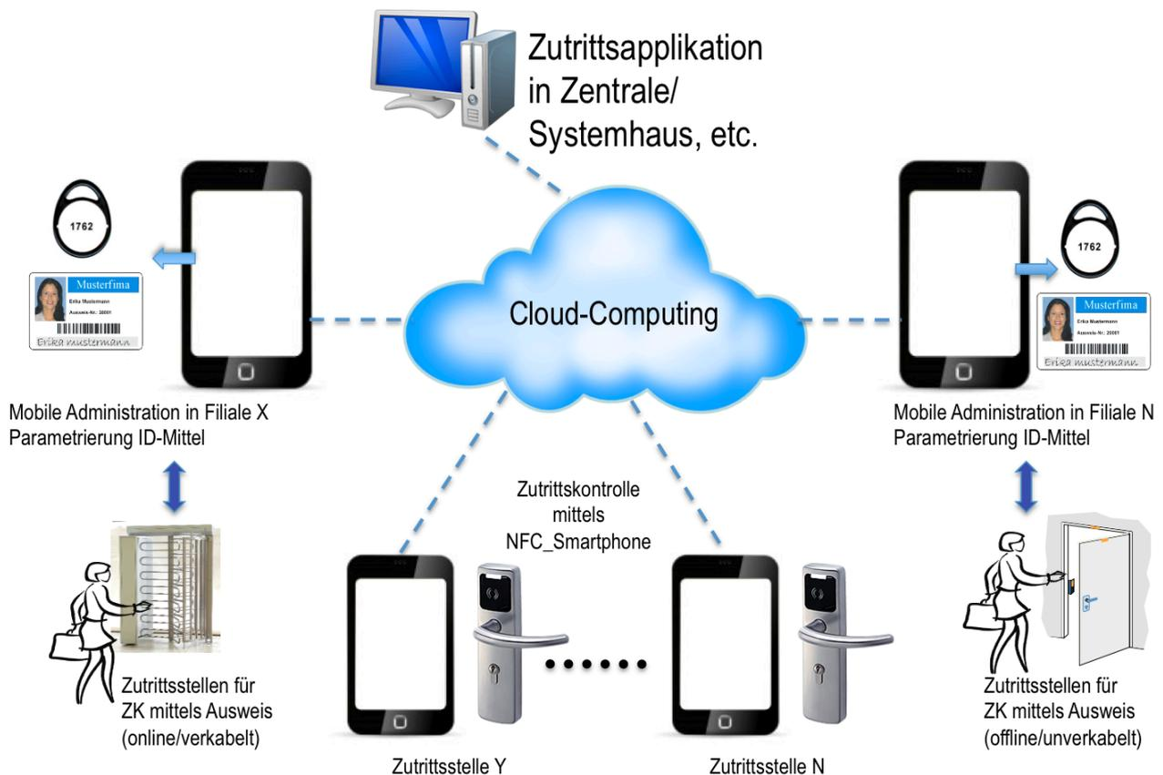
**Abb. 14.01:** Beispiel für die Systemstruktur der Zutrittskontrolle in der Cloud mit Smartphone
