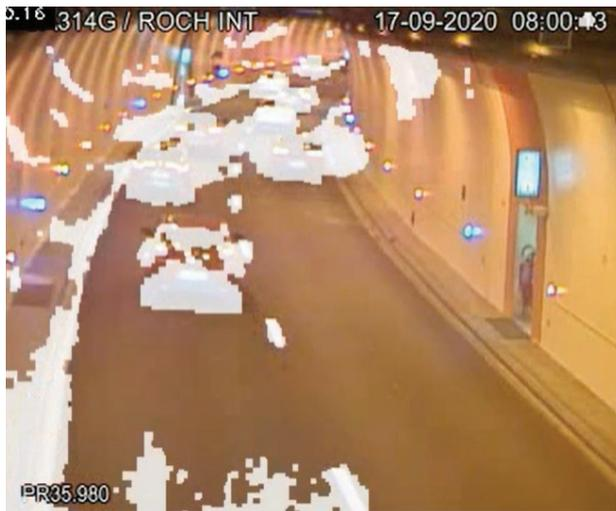
Vor dem Einsatz von KI (bis ca. 2010) konnte die Verkehrsanalyse technisch bedingt nur Pixel-Änderungen detektieren. Derartige Systeme konnten aufgrund der zweidimensionalen Darstellung typischerweise noch keine Objekte differenzieren.
