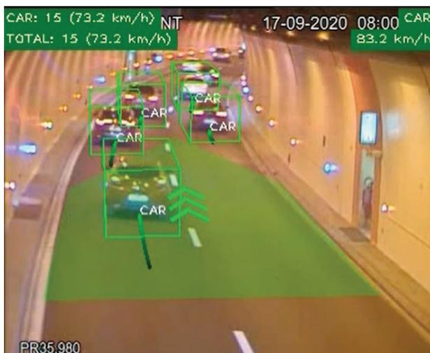
Erkannte Objekte werden dabei durch präzisere Tracking-Boxen abgegrenzt (nachfolgendes Bild). Um die Algorithmen zu trainieren, werden grosse Bilddatensätze aus über 10.000 installierten und im Einsatz befindlichen Videokanälen verwendet.
