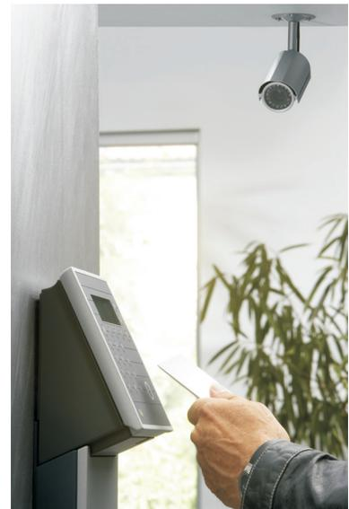
RFID-Identkarte - der Wunsch des Betreibers nach möglichst nur einer einzigen Identkarte für unterschiedliche Anwendungen im Betrieb, z.B. für Zutritt, Kantinenabrechnung, Zeiterfassung etc. leicht erfüllt werden.
