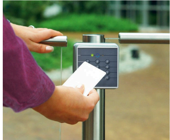
Abb. 6.04: Zutritt mit kontaktloser Chipkarte (mit RFID-Chip)
