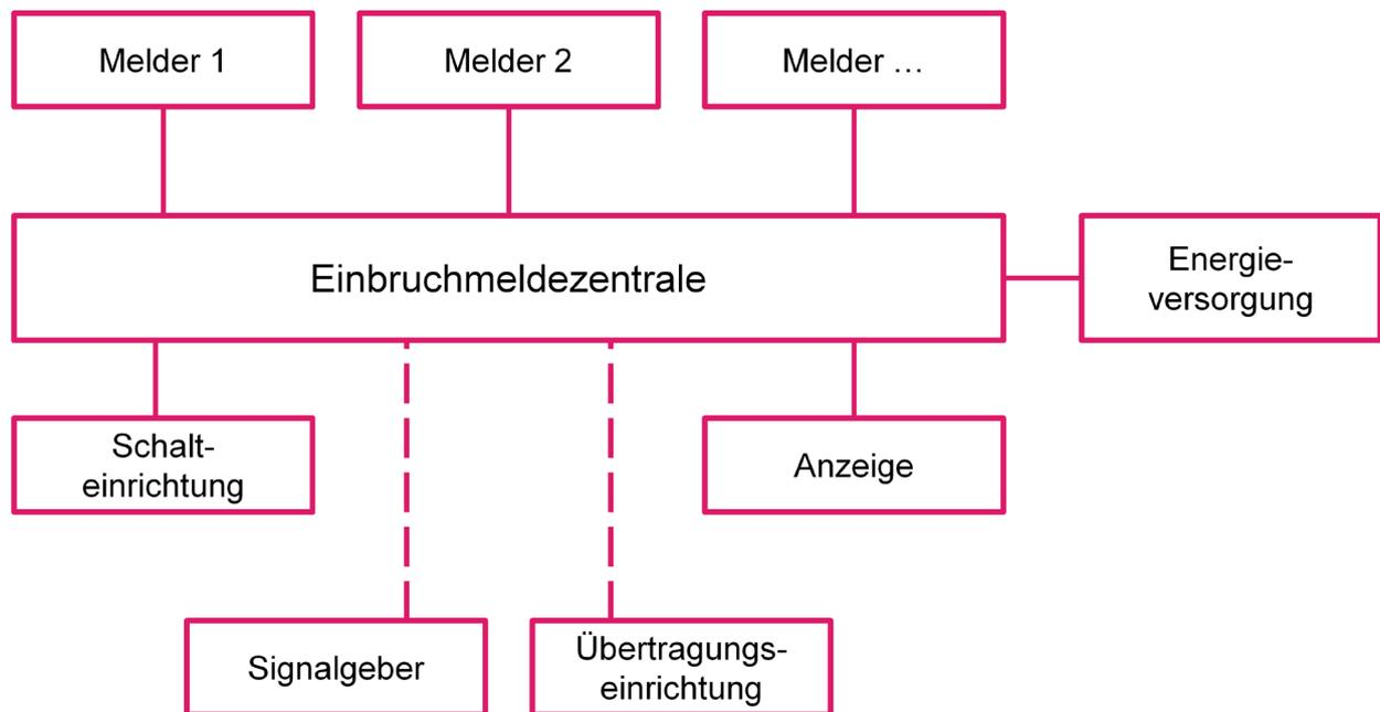
Eine EMA lässt sich über eine Schalteinrichtung „scharf“ und „unscharf“ schalten. Die hierfür notwendigen Komponenten werden häufig an der Tür montiert. Für ihre Bedienung ist i.d.R. ein Schlüssel, eine Chipkarte/Transponder oder die Eingabe eines Codes erforderlich.
