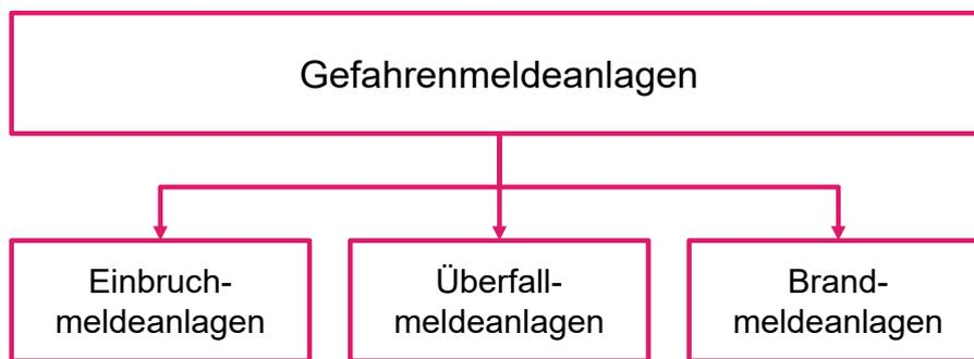
Eine EMA besteht grundsätzlich aus einer Einbruchmeldezentrale, i.d.R. mehreren Meldern unterschiedlicher Bauart und einer Schalteinrichtung zum Aktivieren und Deaktivieren bzw. „Scharf- und Unscharfschalten“ der Anlage. Optional können eine Übertragungseinrichtung sowie optische (Blitzleuchte) und/oder akustische Einrichtungen (Sirene, Signalgeber) zur Alarmierung eingesetzt werden.
