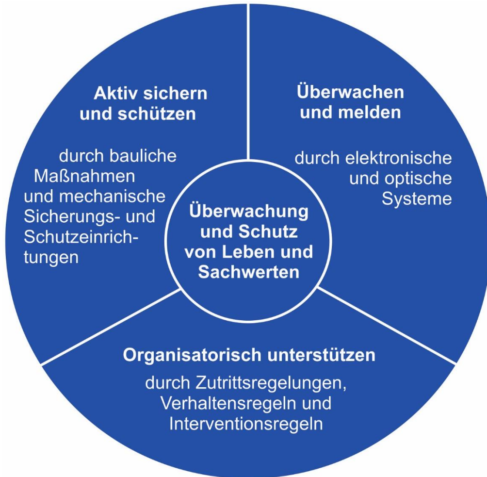
Bild 5-1 Gesamtkonzept von Sicherungs- und Verifikationsmaßnahmen
