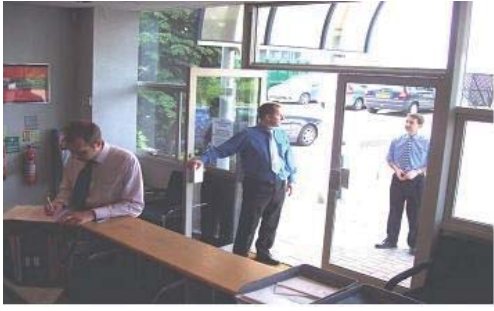
CCD-Kamera Belichtung innen richtig außen überstrahlt
